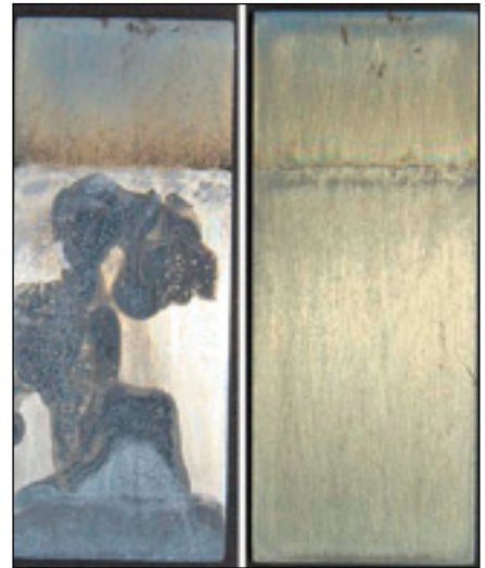
Abb. 3: Korrosionsschutzeffekt einer polymeren Inhibitorschicht auf Zink
